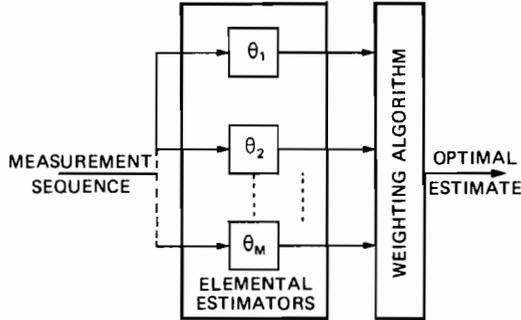
Fig. 12.1 Discrete parameter adaptive estimation.
