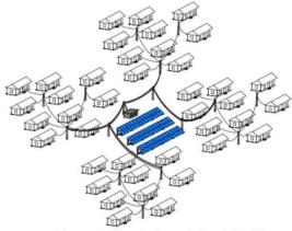
Figure 3: Stand-alone AC mini grid
