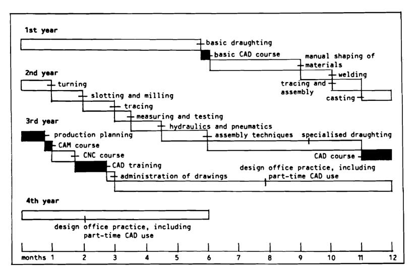
Source: SMS Schloemann-Siemag AG, Modellversuch Technischer Zeichner - Maschinenbau
